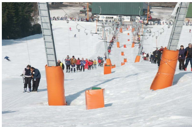
Obrázek 12 – Příklad zajištění bezpečnosti provozu bezpečnostními matracemi
