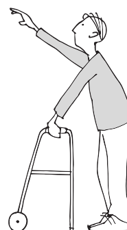
obr. 3 Běžně používané manipulační prvky musí být ve výšce max. 1500 mm nad zemí.
