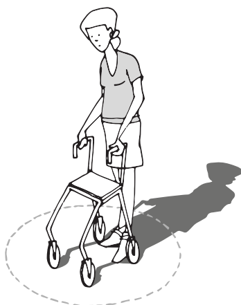
obr. 2 Základním prostorovým požadavkem standardu S120 je manipulační prostor o velikosti kruhu o průměru 1200 mm.
